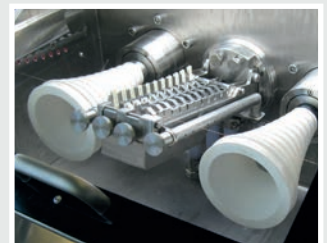
Konenpaar für Feinddraht Ø 30 µm
