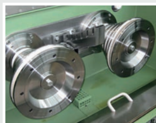
Konenpaar für Grobdraht Ø 3 mm
