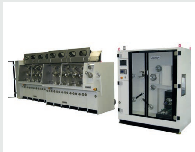
11-zügige Einzelscheibenziehmaschine mit Nachzug und traversierendem Spuler; integration einer Inline Glühe möglich
