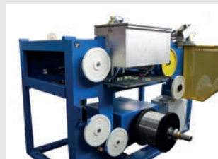
Ziehspuler mit Ultraschall Reinigung
