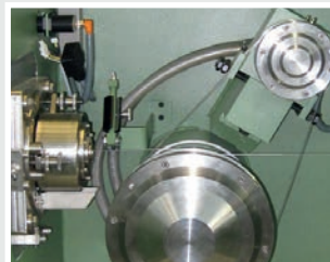
Wassergekühlte Endzieh- und Spreizscheibe, rotierende Endziehsteinhalter
