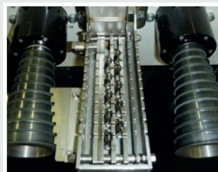
Konenpaar für Feinddraht Ø 12 µm
