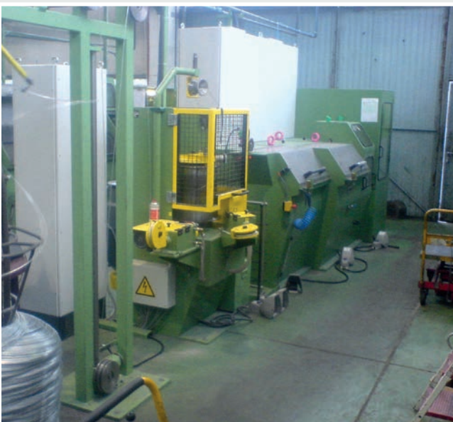
Drahtziehmaschine Type 150-40 Einlauf-Ø bis 3,0 mm, mit Vorblock und Pinolenspuler
