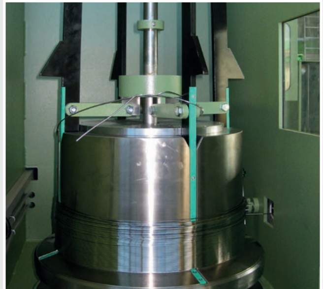
Ausrüstung mit Schollkegel und Abhebekorb für Ringfertigung
