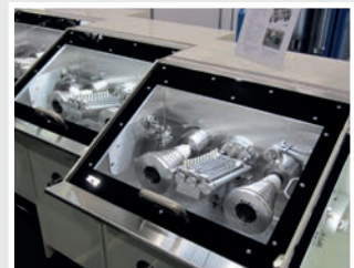
Konenziehmaschine in Modulbauweise mit Einzelantrieben
