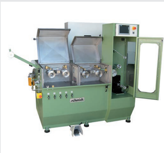
drawing machine for precious metals 0,06 - 0,15mm mit traversig winder
