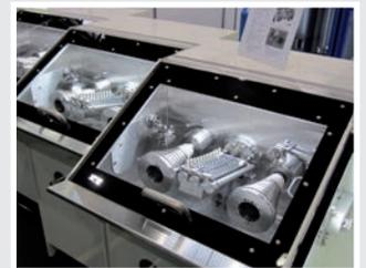
Konenziehmaschine in Modulbauweise mit Einzelantrieben
