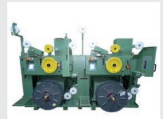
Traversierender Spuler für Spulen bis Ø 800 mm
