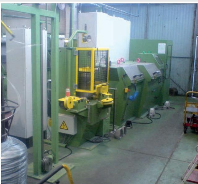
Drahtziehmaschine Type 150-40 Einlauf-Ø bis 3,0 mm, mit Vorblock und Pinolenspuler
