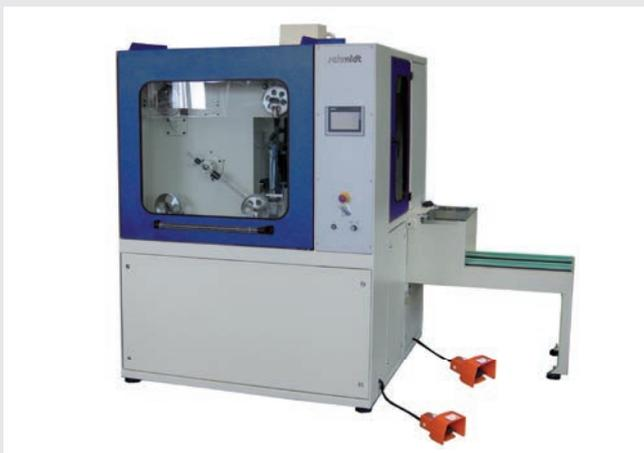
Automatikspuler Typ A250-355 mit Magazin für 5 Spulen
