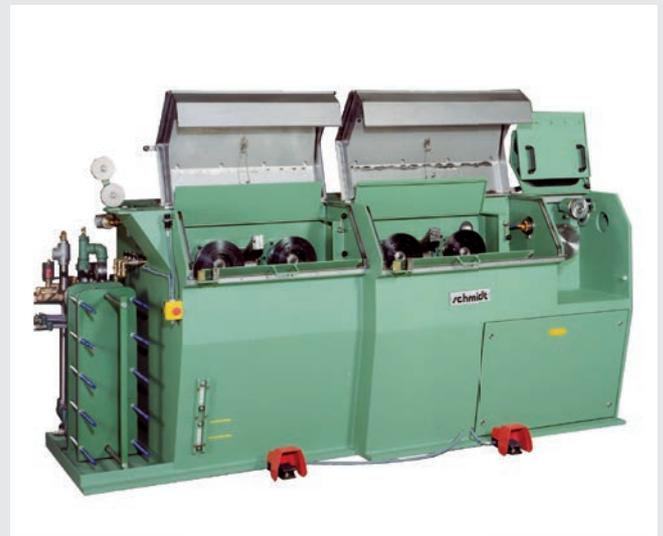
Drahtziehmaschine Typ 150-40
