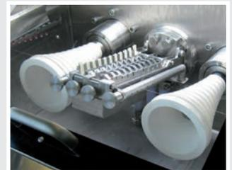
Konenpaar für Feindraht Ø 30 µm
