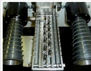
Konenpaar für Feindraht Ø 12 µm
