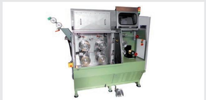
Konenziehmaschine für Edelmetalle mit 2 Konen Paaren
